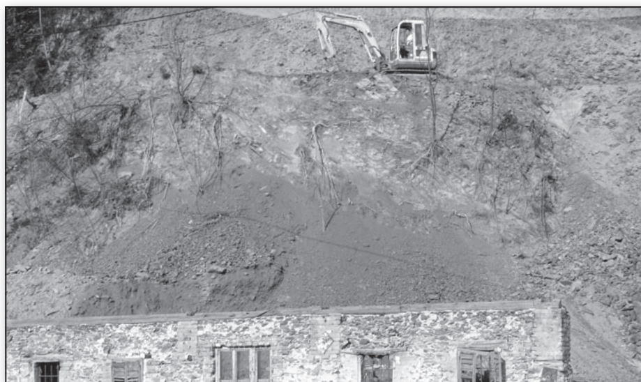
Močno zdrobljeni in različno prepereli temno sivi, olivno sivi, oranžno rjavi in rjavo rdeči ploščasti permokarbonski sedimenti (skrilav glinavec, sljudnat kremenov meljevec in peščenjak) ob dolenjski cesti na Lavrici. Zid porušene stare hiše, zgrajen pretežno iz ploščastih kosov permokarbonskih kamenin dokazuje, da so domačini uporabljali permokarbonske kamnine kot gradbeni material.
